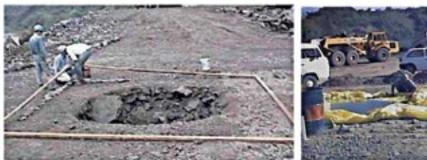
**Figura 23.** Ensaio de densidade *in situ* de enrocamento.
