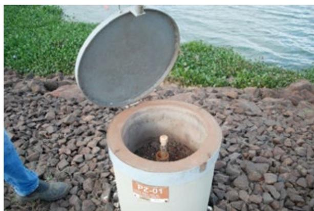
**Figura 1.9.** Piezômetro de tubo na barragem de Canoas II (Brasil) bem identificado e com boa proteção.
