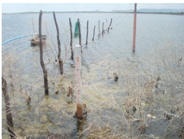
**Figura 1.8.** Barragem de Baião (Paraíba) – escalas para registro do nível de água do reservatório.
