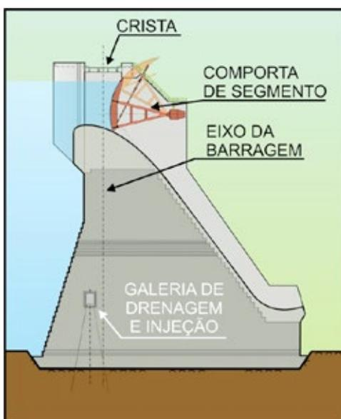
**Figura 1.22.** Galeria de drenagem e injeção.
