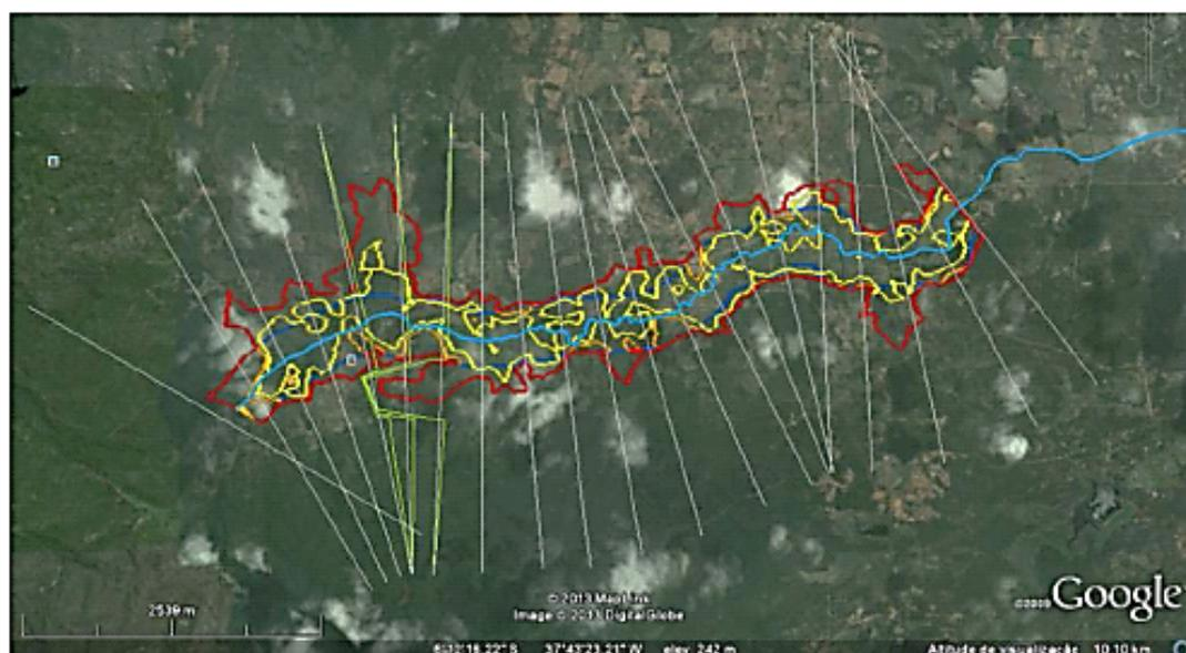
**Figura 4. Áreas de inundação e desenho das seções utilizadas para a sua determinação importadas para o Google Earth. Classificação de Barragens da ANA. (Fonte: Banco Mundial, 2014)**
