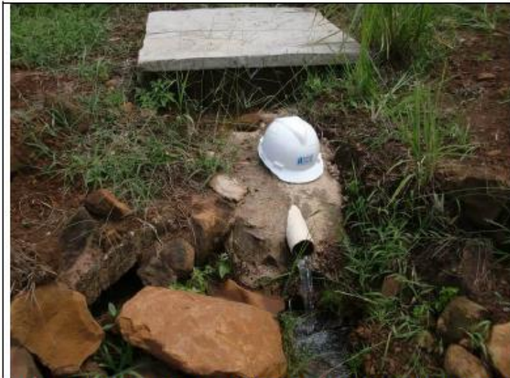
Fig. 6.1 – Detalhe da medição de vazão, a qual foi realizada cinco vezes, com média de 35,9 l/min em Nov/2015.
