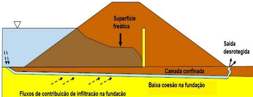
Erosão interna na fundação
