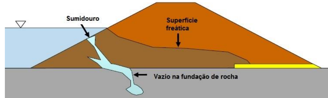
Erosão interna ao longo do contato barragem-fundação
